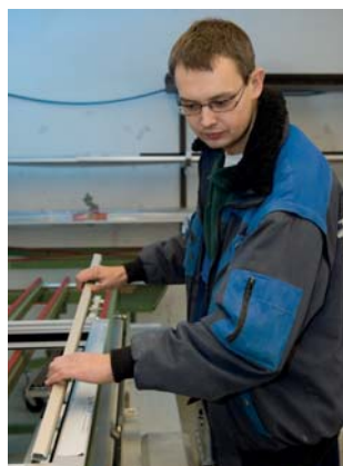
Glasleisten in den Fensterrahmen einpassen.
